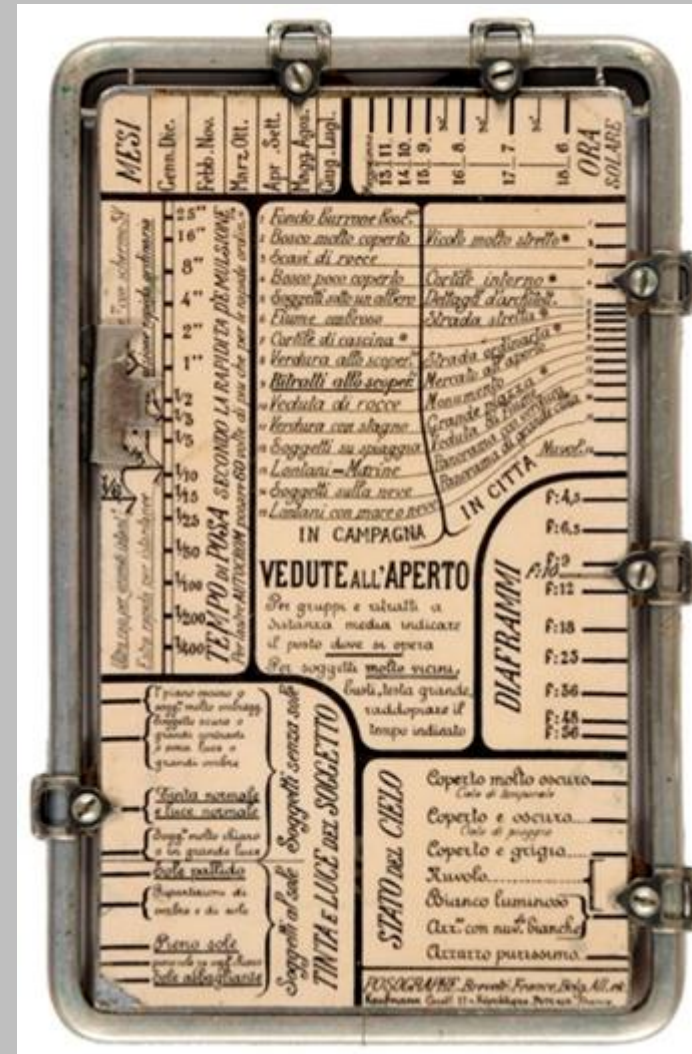
Le Posographe. Brevet : France, Belg[ique], All[emagne] etc. Belichtungs-Rechenchieber mit italienischer Beschriftung, 13,5 x 9 cm, 1923. / KAUFMANN, Constr., 11 rue Republique, Puteaux, France. Copyright photobibliothek.ch
